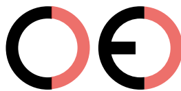
Marca CE falsa (demasiado separados)
